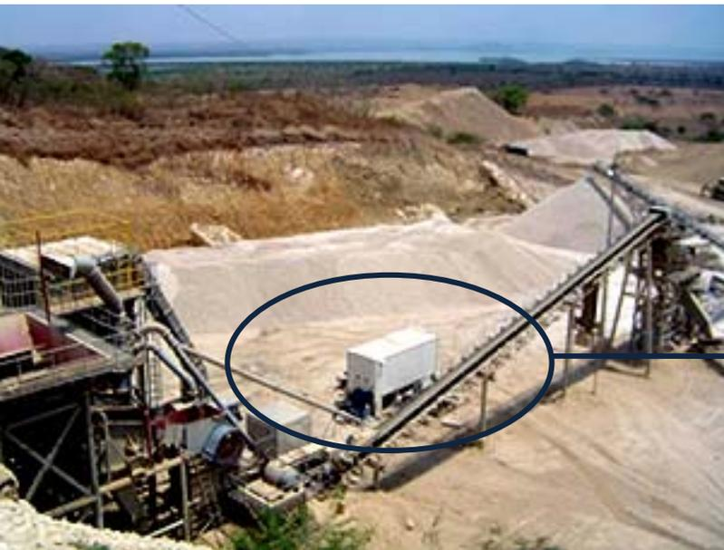
Subestación 800 Kva 13200 / 460 / 220 Vac para operación automática de la planta de trituración de AGRECON en Arroyo de Piedra Atlántico.
